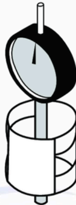
Figura F.4 – Equipamento recomendado para medir a profundidade das moccas
